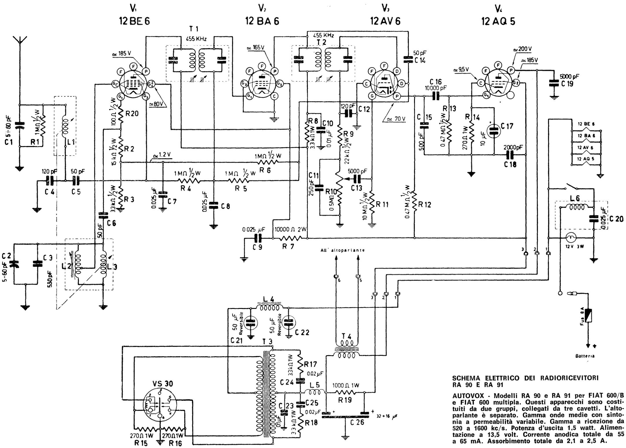
SCHEMA ELETTRICO DEI RADIORICEVITORI RA 90 E RA 91
